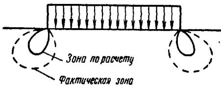
Рис. 94. Зоны предельного равновесия в основании сооружения
