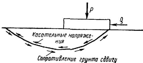
Рис. 85. Смещение части основания по поверхности скольжения
